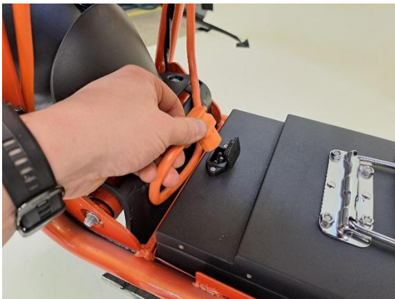
Laita pistoke kiinni akkuun.
