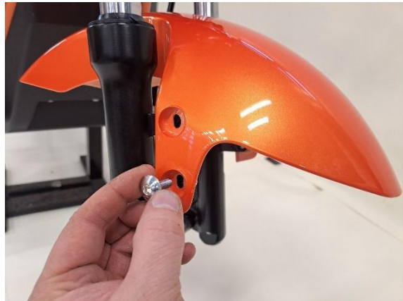
Kiinnitä etulokasuoja neljällä kupukantaisella kiinnityspultilla (kuusiokoloavain 5mm).
