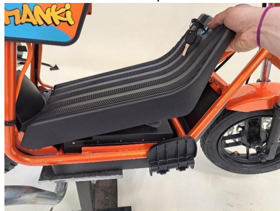
Laita akkukotelon kansi paikoilleen.
