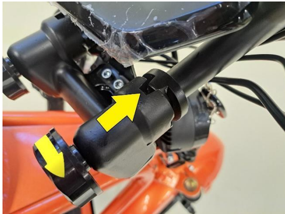
Katso, että ohjaustangon puolikkaat lukkiutuvat paikoilleen. Kiristä ohjaustangon puolikkaat kiristysrullasta.
