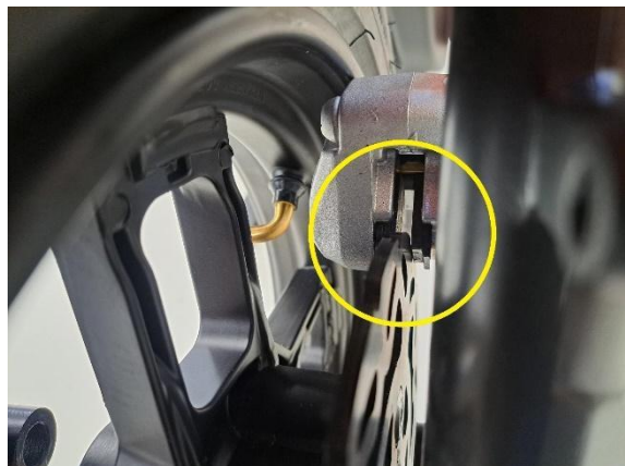
Katso, että jarrulevy asettuu etujarrupalojen väliin.
