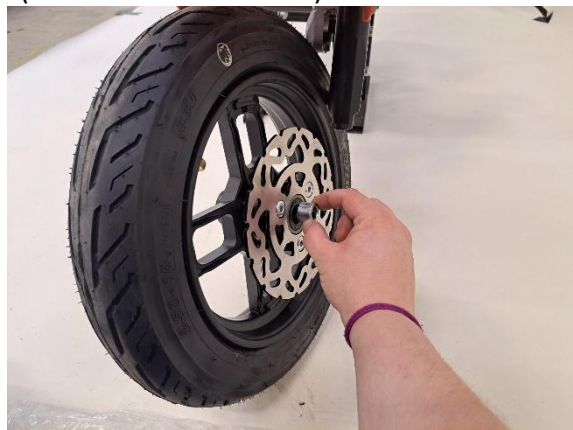
Laita lyhyempi holkki etupyörään jarrulevyn puolelle.
