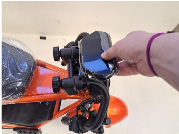
Laita mittaristo paikoilleen irroitetuilla kiinnityspulteilla (kuusiokoloavain 5mm).
