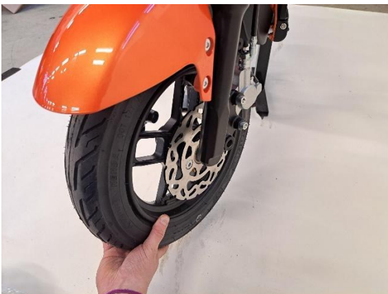
Nosta etupyörä paikoilleen.
